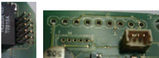
Anschlüsse für Sensor + Aktor: Herausgeführte Pins
